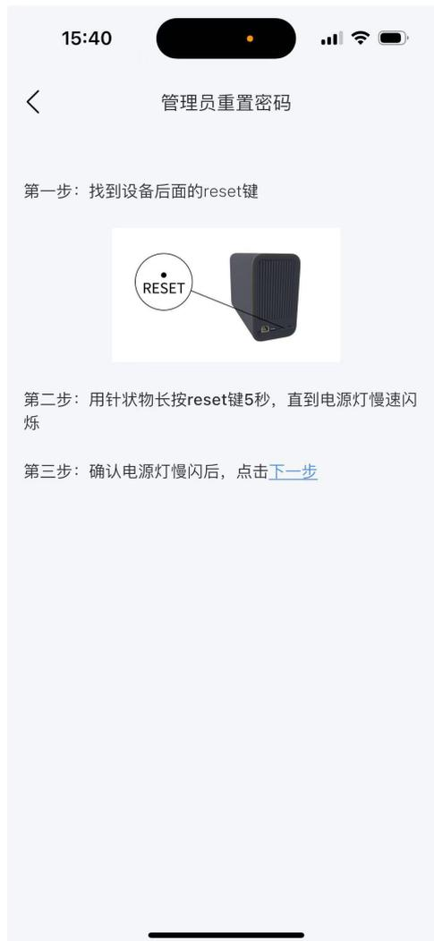
**步骤 3：** 将针状物插入设备后面的 reset 口，长按 5 秒，当前面板中的电源灯“绿色慢闪”
